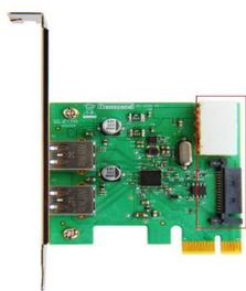
请务必将计算机电源供应线连接到此 4-pin or 15-pin 电源连接插头,以确保能提供 USB3.0 装置有足够电力。
