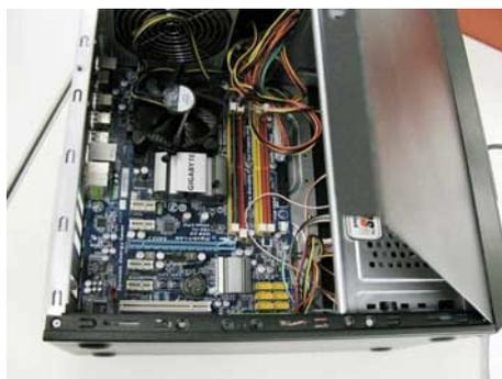
3. 请选择一个 PCE Express 插槽（较长或较短的插槽均可使用），移除其后方的金属挡板。
