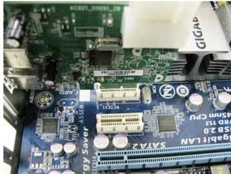
6. 将 USB 3.0 扩充卡后方的螺丝孔以适合的螺丝锁上，以加强扩充卡的稳固。
