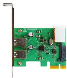
**USB 3.0** デバイスを動作させるには必ず **4 ピン/15 ピン**の電源コネクタを接続して電源供給を行ってください。
