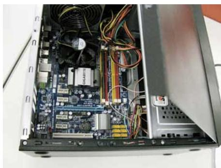
3. USB 3.0 拡張カードを取り付ける PCI Express スロットを決め、スロット横にあるメタルブラケットやプレースホルダーを外します。(USB 3.0 拡張カードは x1/x2/x4/8/16 のスロットに対応しています。)
