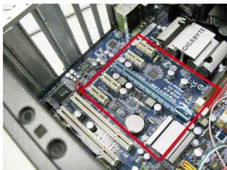
4. コンピュータの利用可能な 4 ピン/15 ピンの電源コネクタを USB 3.0 拡張カードに接続します。
